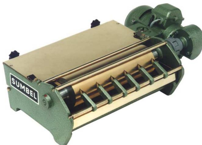
Les encolleuses **ENANO** sont des modèles économiques et efficaces pour fonctionner avec des colles vinyliques ou à base aqueuse.
