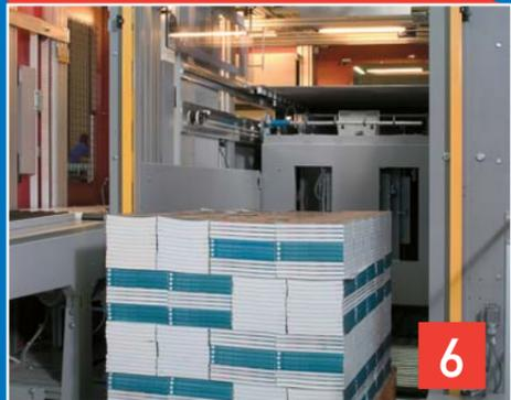
ÉLÉVATEUR DE PALETTE: Le plan élévateur de palettes est constitué de rouleaux et la sortie pour les palettes complétées se vérifie à travers un convoyeur à rouleaux motorisé qui en garantit la stabilité dans l'éjection de tout type de palette.
