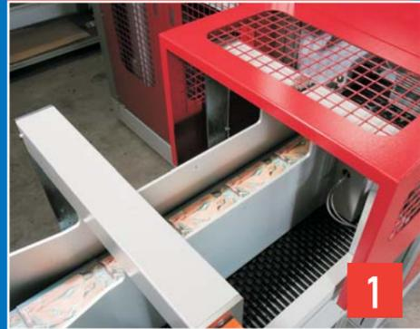
CONVOYEUR À ROULEAUX MARQUE-PAS: Le produit est introduit dans la machine à cadence régulière à travers un convoyeur à rouleaux marque-pas d'accumulation.
