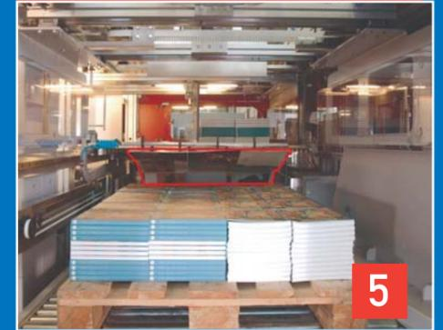
CHARGEUR DE L'INTERCALAIRE: Le chargeur automatique donne la possibilité de déposer l'intercalaire sur la palette vide ou sur différentes couches (programmable par le tactile).
