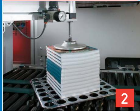
POSTE DE ROTATION: Le poste volte-piles tourne les produits de 90° à droite et à gauche et de 180° suivant la configuration du schéma de palettisation requis par le programme. Les produits sont élevés et maintenus en position par un disque de pression pendant la rotation.
