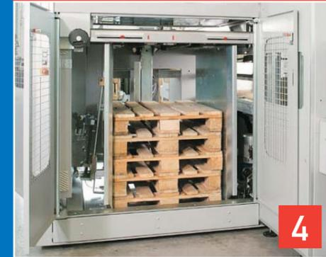
MAGASIN DES PALETTES: Le magasin des palettes a été réalisé pour contenir et usiner une vaste gamme de palettes de différents types et dimensions.
