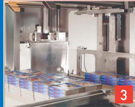
**COMPOSEUR DE RANGÉES:** chaque rangée préparée par le composeur est transportée sur le composeur couches jusqu'à ce que le plan soit complété. Avec chaque rangée en arrivée, le tapis du composeur couches effectue un mouvement en avant pour garantir un transport délicat du produit.
