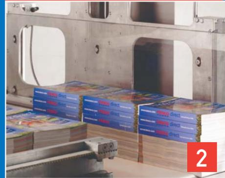
**COMPOSEUR DE RANGÉES:** le produit est organisé en rangées sur le composeur en créant, là où nécessaire, des espaces vides. La raclette poussant les rangées est pourvue d'un système de soufflage pour garantir un transport délicat et homogène du produit.
