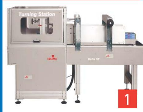
**CONVOYEUR À ROULEAUX DU MAGASIN ET POSTE DE ROTATION:** le produit en arrivée est tourné par le poste de rotation à grande vitesse et préparé pour construire la disposition de la palette comme précédemment programmée sur la machine par l'opérateur.
