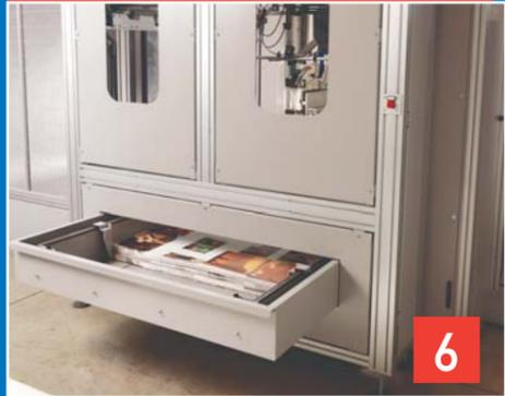
**DISPOSITIF INTERCALAIRE:** le dispositif pour l'intercalaire est constitué d'un grand tiroir pour le chargement du papier et d'un bras à ventouses pour la prise et la dépose de l'intercalaire sur la palette vide ou entre les différentes couches de produit (lorsque requis).
