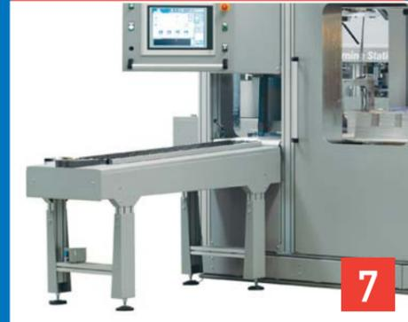
**SORTIE EN LIGNE:** La machine est pourvue d'une sortie en ligne qui permet de décharger manuellement les produits du convoyeur à rouleaux libres.
