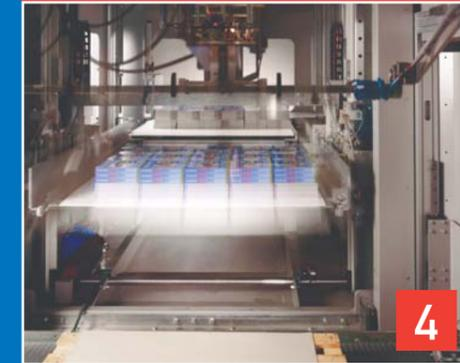
**CONVOYEUR DE TRANSFERT:** le plan de produits construit sur le composeur couches est transporté sur le convoyeur de transfert qui, en se déplaçant longitudinalement et verticalement, se positionne sur la palette en construction. Lorsque les barrières latérales se sont mises en position autour du produit en assurant sa stabilité, le convoyeur de transfert retourne dans la position de chargement, prêt à recevoir la couche suivante.
